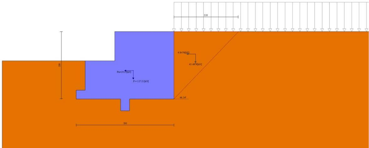
Fig. 5 - Cuneo di spinta (combinazione sismica) (Combinazione n° 2)
