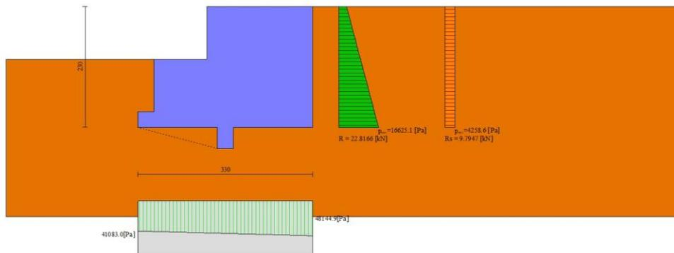
Fig. 6 - Diagramma delle pressioni (combinazione sismica) (Combinazione n° 2)
