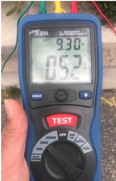
FOTO 5. – Misura della resistenza di terra
