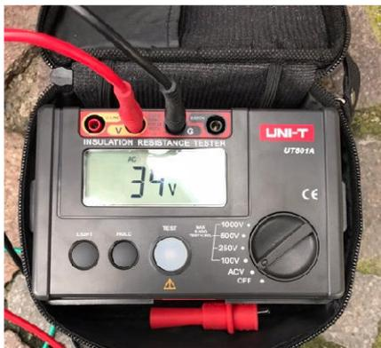
FOTO 25. - Misura della caduta di tensione a fine linea
