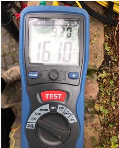
FOTO 21. – Misura della resistenza di terra
