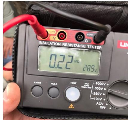
FOTO 22. – Misura della resistenza di isolamento
