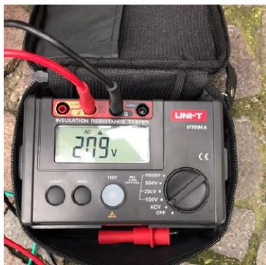
FOTO 23. – Misura della caduta di tensione a fine linea
