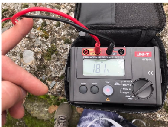
FOTO 15. – Misura della Caduta di tensione L3-N
