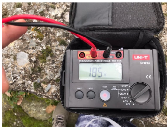
FOTO 14. – Misura della Caduta di tensione L2-N
