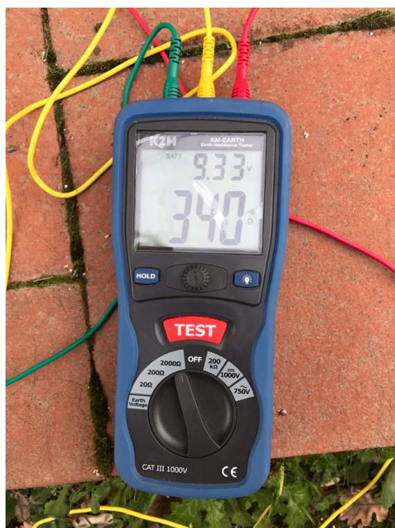
FOTO 11. – Misura della resistenza di terra
