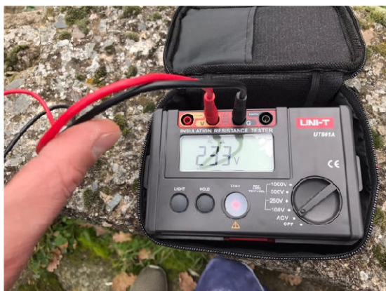
FOTO 13. – Misura della Caduta di tensione L1-N
