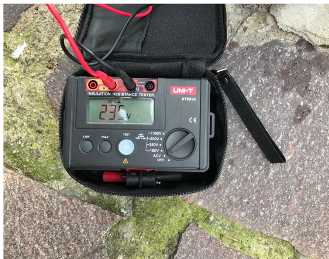
FOTO 22. – Caduta di tensione a fine linea
