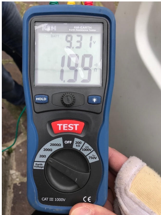
FOTO 19. – Misura della Resistenza di terra
