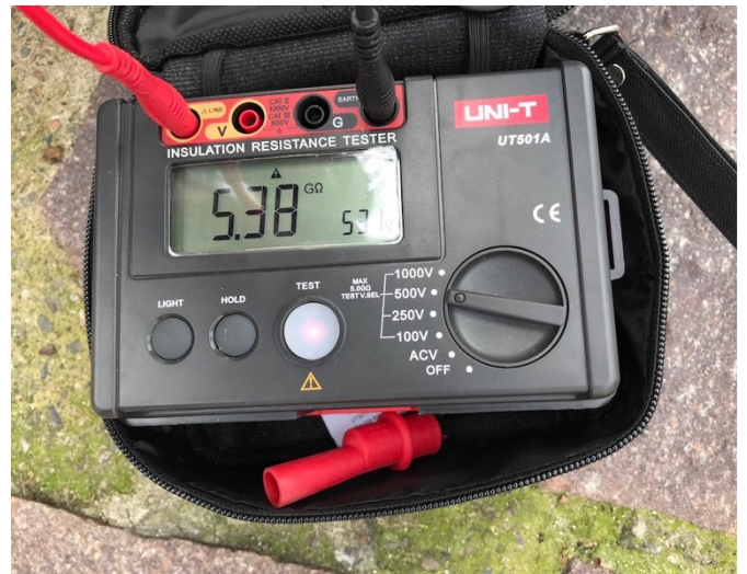
FOTO 20. – Misura della Resistenza di isolamento
